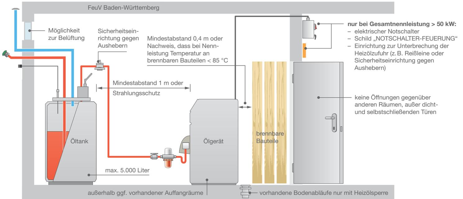
Befinden sich Feuerstätte und Lagerung von  $> 1.000\text{ l}$ , jedoch  $\leq 5.000\text{ l}$  Heizöl in einem Raum oder handelt es sich um eine Feuerstätte  $> 50\text{ kW}$ , darf der Aufstellraum nicht anderweitig genutzt werden, ausgenommen zur Aufstellung von Wärmepumpen, Blockheizkraftwerken und ortsfesten Verbrennungsmotoren sowie zur Lagerung von Brennstoffen.
