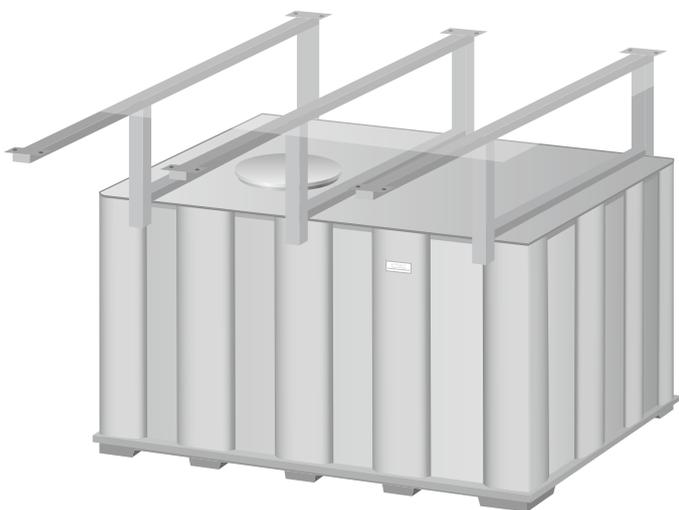
Abbildung 10: Auftriebsicherung, Bsp. standortgefertigter Stahltank
