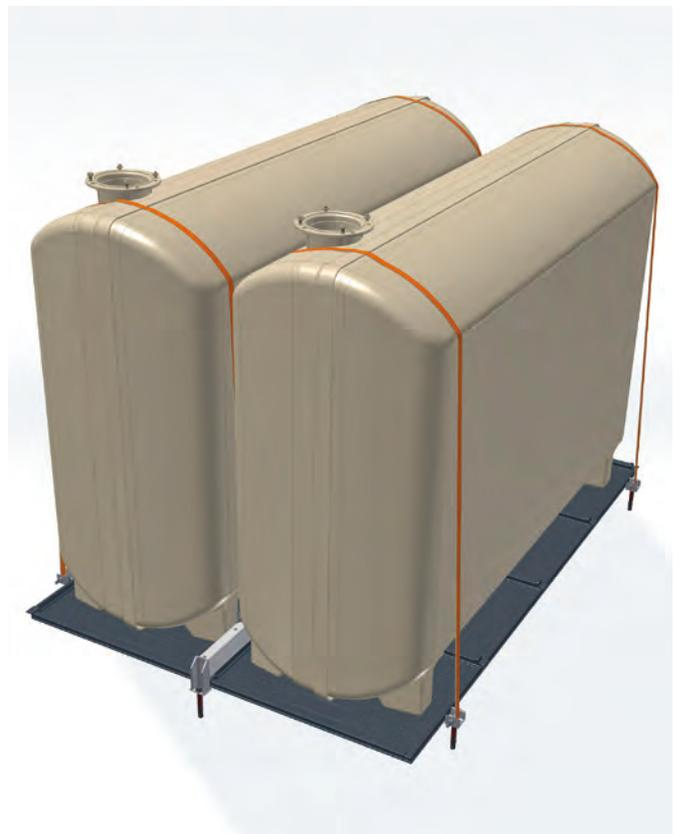
Abbildung 18: Hochwassersichere Aufstellung (Bsp. Fa. CEMO)
